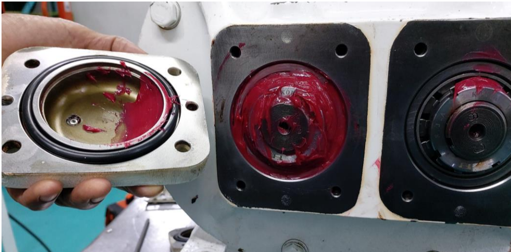
3. Limpieza y lubricación de rodamientos frontales.
