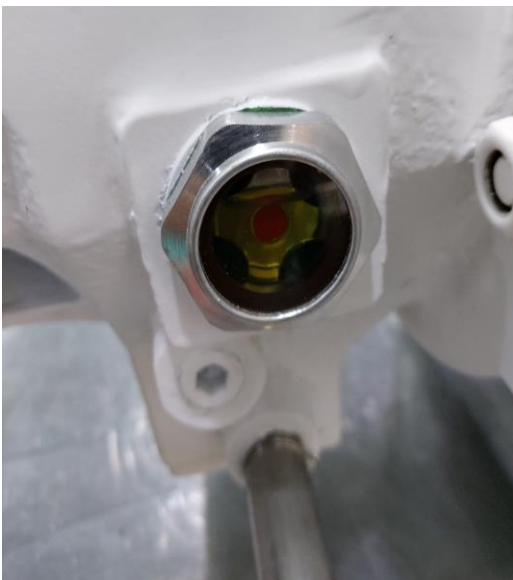
4. Aplicación de aceite de transmisión serie Alchemist nuevo y cambio de mirillas.
