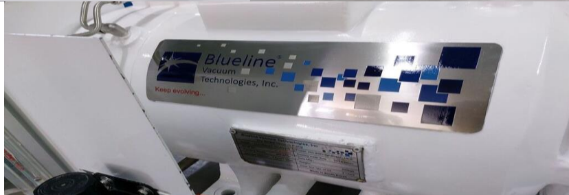
5. Limpieza exterior y pintura en bomba para envío a planta.
