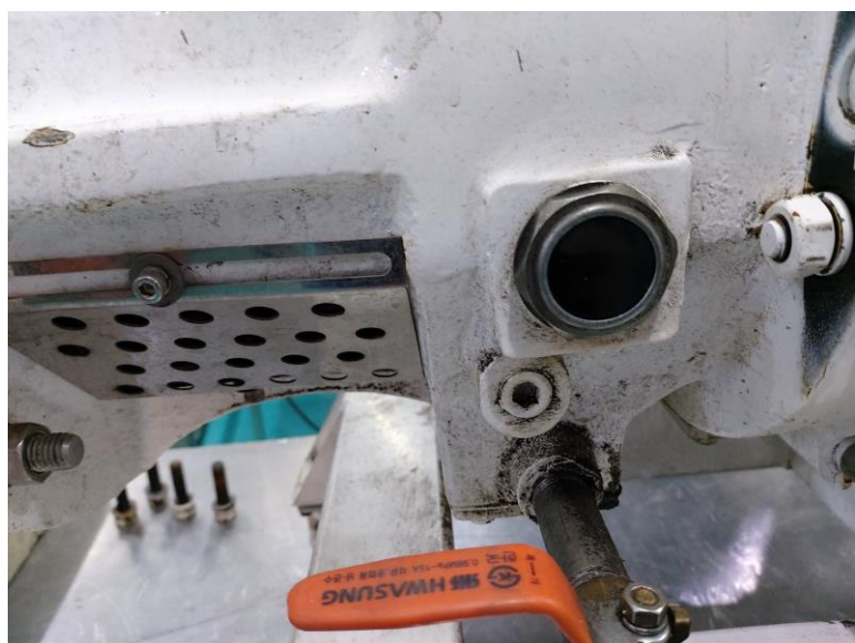
4. Aplicación de aceite de transmisión serie Alchemist nuevo y cambio de mirillas.
