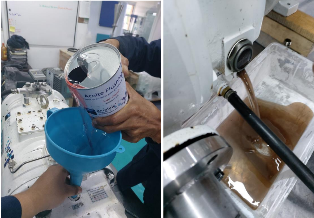
1. Limpieza con aceite Flushing en la cámara de engranes.
