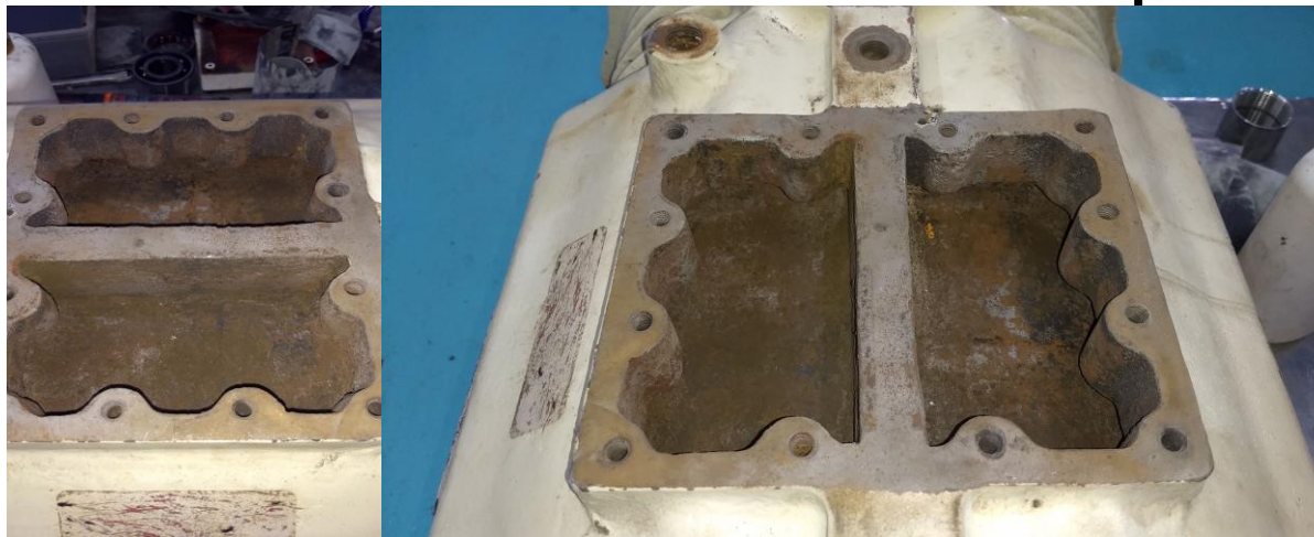
Tratamiento de limpieza del enchaquetado de enfriamiento.
