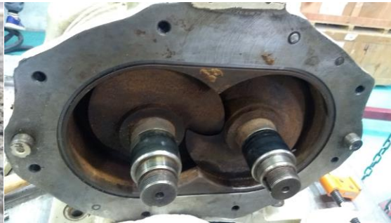
Mangas Cerámicas dañadas.
